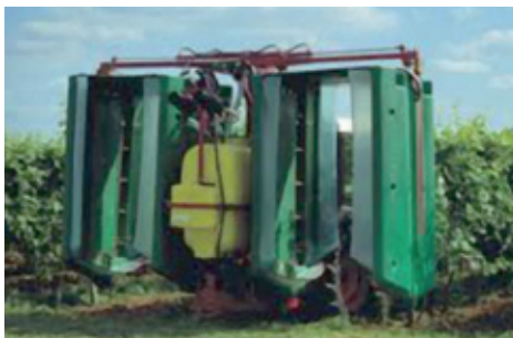
Fig. 23 : Pulvérisateurs équipés de panneaux récupérateurs
