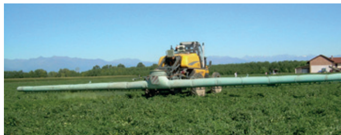
Fig. 24 : Pulvérisateur avec manchon d'air
