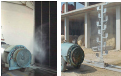
Fig. 10 : Deux exemplaires de bancs de répartition verticale
